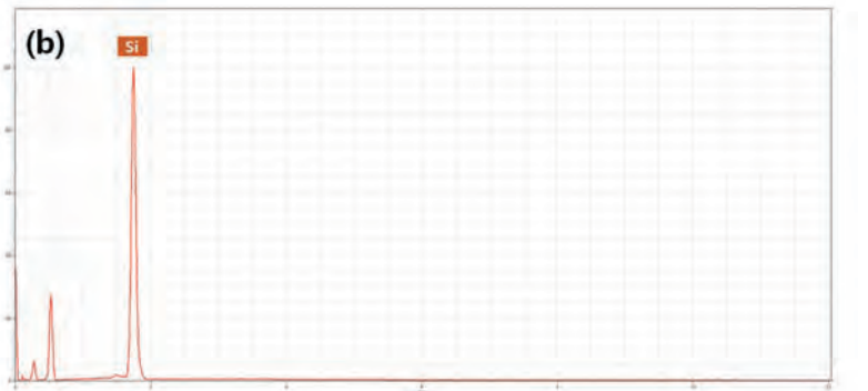
도판 9. 칠반(29-①) 바탕층 토분의 SEM-EDS 분석 결과 [(a): SEM image(×100), (b): EDS spectrum]
