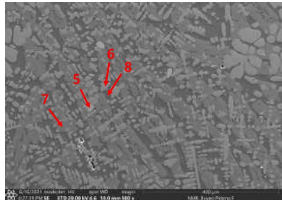
그림 35. 슬래그 2-1의 주사전자현미경 이미지와 성분 분석 부위.(a 그림 5-b 철 부위, b 그림 5-d의 슬래그 부위)
