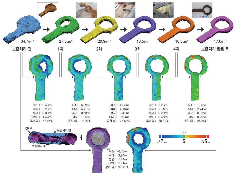
도4. 철제 환두부의 보존처리 과정별 입체형상 변화 및 3차원 편차분석 결과.
