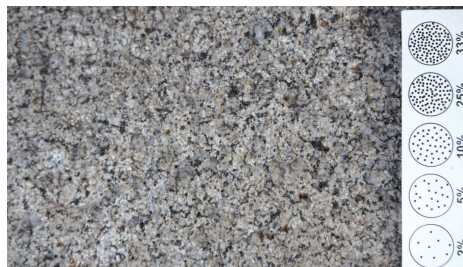
도6. (a) 천수사 오층석탑의 암석 산출상태. (b) 1~3mm의 중립질, 반상 조직인 약 20의 색지수의 복운모 화강암. (c) 2~5mm의 중립질, 반상 조직의 석영, 정장석, 사장석 및 흑운모로 구성된 약 15 색지수를 보이는 흑운모 화강암. (d) 중립질, 반상 조직을 보이는 복운모 화강암 내 장석 반정. (e) 복운모 화강암 내 5×2cm의 장석 반정 내 고철질 광물누대. (f) 복원 암석 내 장석 변질
